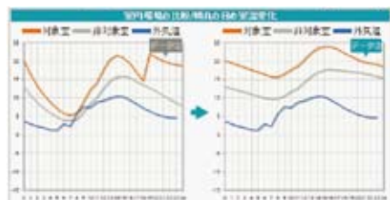
温熱性能計算ツールで 暖房室・非暖房室の温度差を示し ヒートショックのリスクを伝える例
